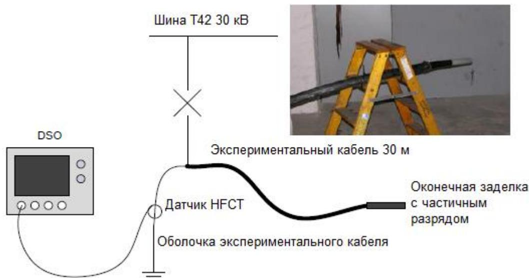
Рисунок 6: Испытательная установка с образцом кабеля
