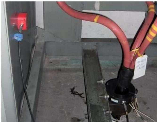
**Рис 8. Измерение ЧР по двум каналам в режиме наложения**
