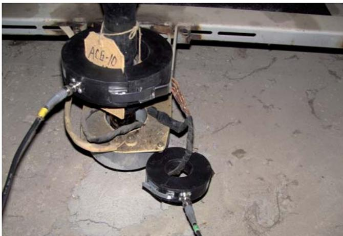
В данном случае продемонстрированы два варианта подключения на одном кабеле. При этом прибор отображает показания по двум независимым каналам с возможностью отдельного просмотра каждого канала или в формате наложения показаний.
