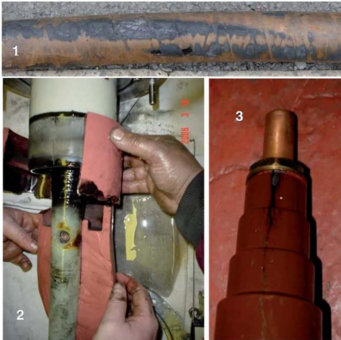
1 — следы ЧР в кабеле БМ 11 кВ; 2 — следы ЧР во второй фазе трансформатора 110 кВ; 3 — следы ЧР в оборудовании. Данные примеры выявлены специалистами HVPD при помощи установки Longshot.
