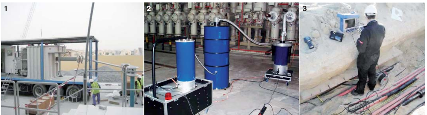
1 — резонансная система 132 кВ; 2 — система OWTS 150 кВ; 3 — прибор Logshot, диагностика до 700 кВ (можно использовать с высоковольтной установкой для OFF-LINE-диагностики)
