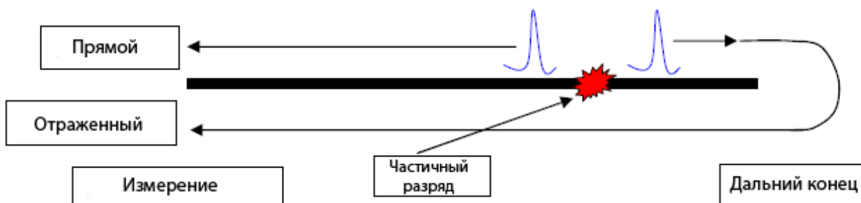
Рисунок 15: Метод одностороннего обнаружения места частичного разряда.
