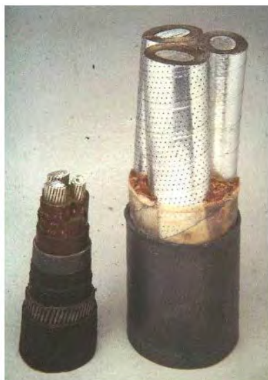
Рисунок 6: Слева: кабель PILC 11 кВ с поясной изоляцией, справа: трехжильный кабель PILC 33 кВ
