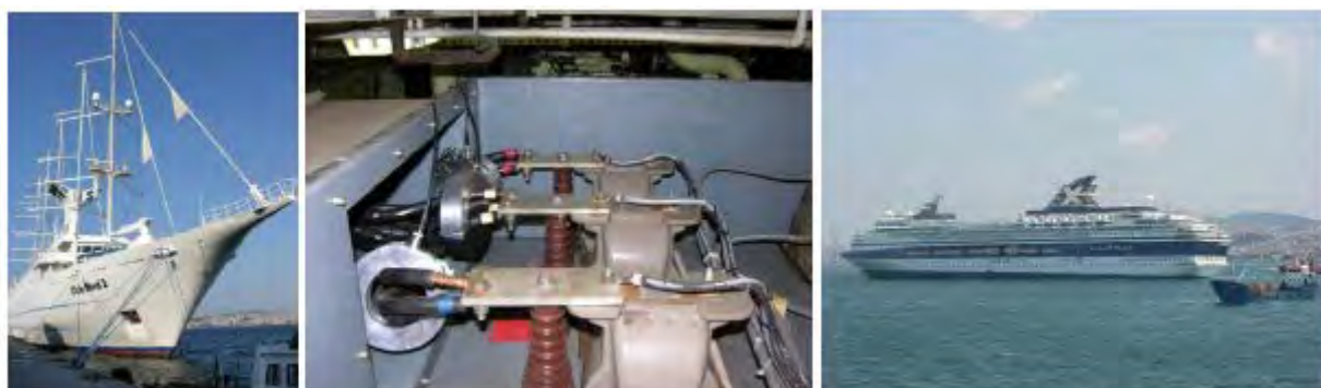
Тестирование частичного разряда на высоковольтных машинах круизных судов в рабочем режиме – клиент V.Ships, Монако.
